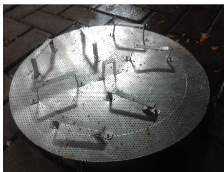
Figura 37: Filtro danificado após brassagem
