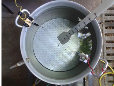
Figura 36: Montagem para medição de temperatura
