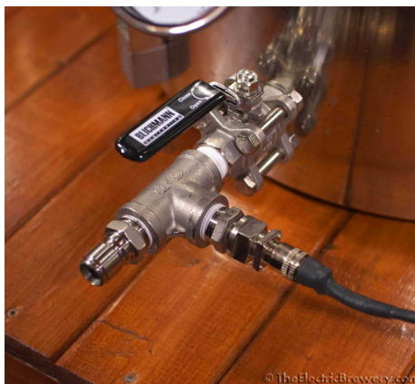
Figura 20: Montagem do Sensor de Temperatura para Mostura
